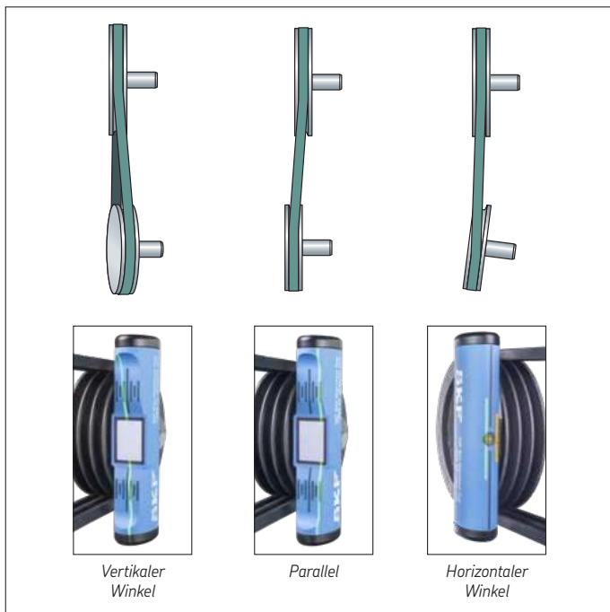
Abbildung 5 Zusammenfassung möglicher Fehlausrichtungen
