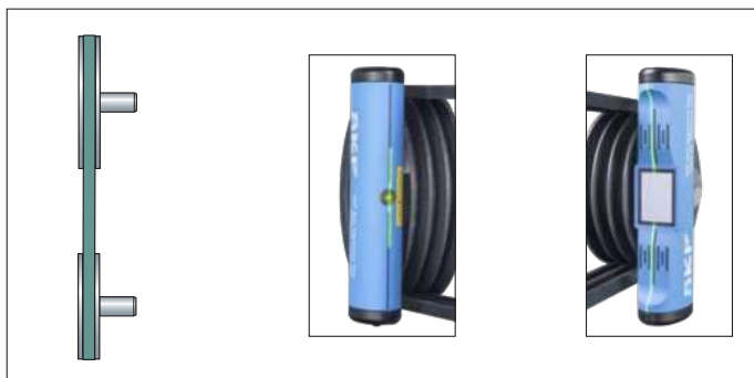
Figure 9 Pulegge perfettamente allineate
