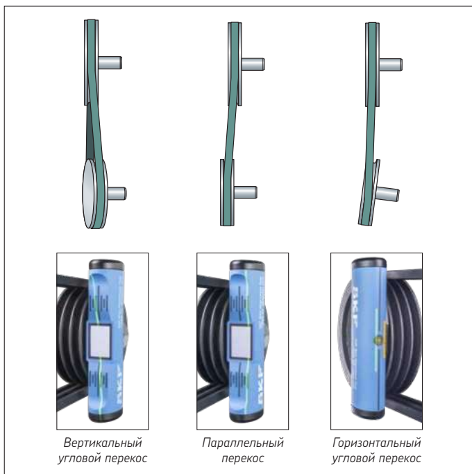
Рисунок 5 Определение типа перекося
