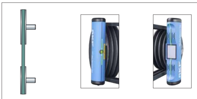
Рисунок 9 Соосность шкивов после правильно выполненной выверки
